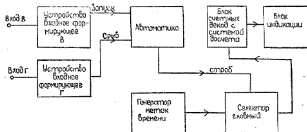
Рис. 4. Структурная схема измерения интервалов времени и длительности импульсов.
