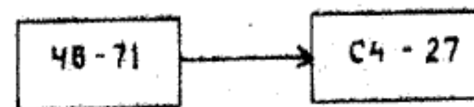
Рис.10. Структурная схема измерения комбинационных составляющих спектра выходного сигнала.
