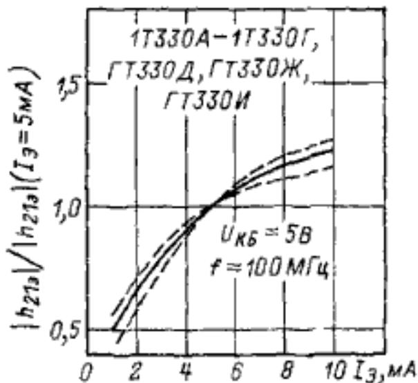
Зона возможных положений зависимости относительного модуля коэффициента передачи тока от тока эмиттера
