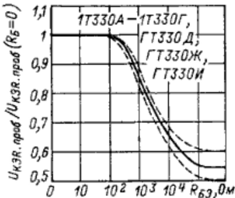
Зона возможных положений зависимости относительного пробивного напряжения коллектор-эмиттер от сопротивления база-эмиттер.
