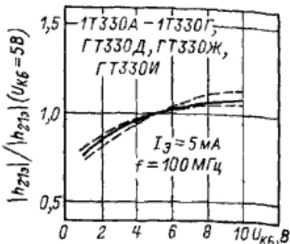
Зона возможных положений зависимости относительного модуля коэффициента передачи тока от напряжения коллектор-база.
