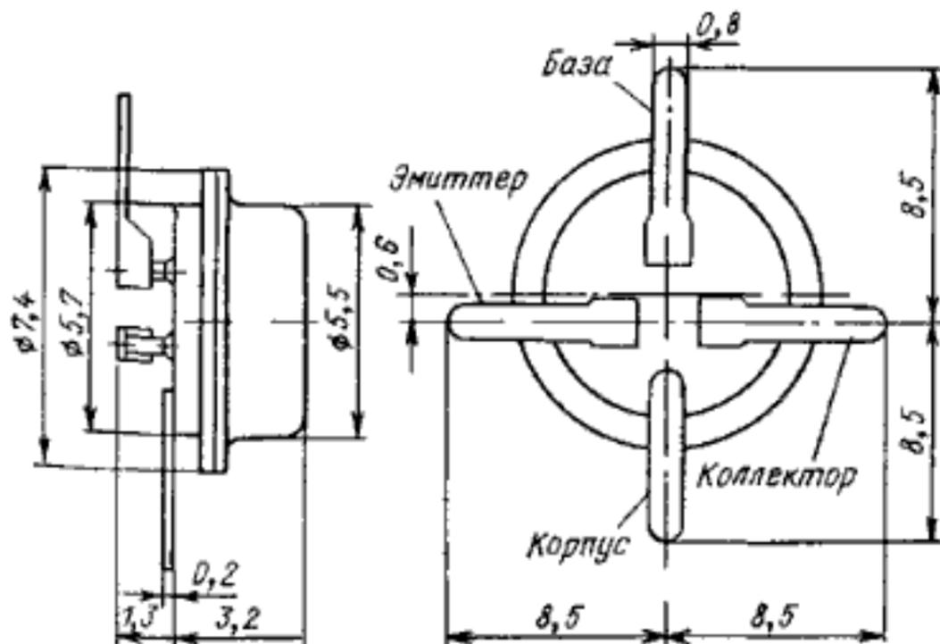
Предназначены для усиления и генерирования электрических сигналов.
