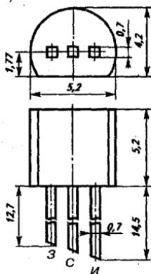
Транзистор кремниевый планарный с каналом р-типа. Предназначен для применения в усилительных и переключающих схемах. Выпускается в пластмассовом корпусе с жесткими выводами, тип корпуса КТ-26. Масса транзистора не более 0,5 г.
