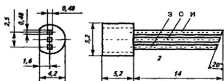
Транзисторы кремниевые эпитаксиально-планарные полевые с диффузионным затвором и каналом  $n$ -типа. Предназначены для применения в маломощных усилителях и схемах зарядочувствительных предусилителей. Выпускаются в пластмассовом корпусе с жесткими
