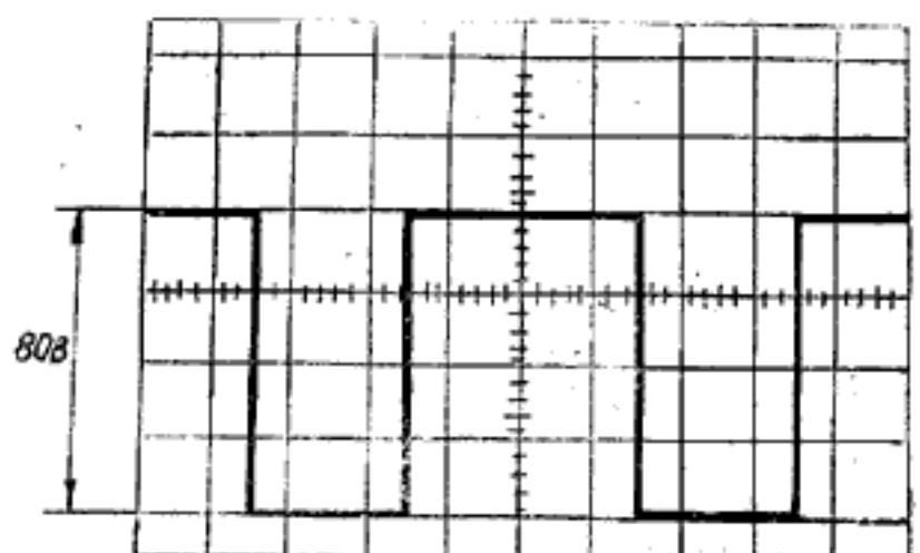
Рис. 9. Форма и амплитуда импульса подсвета.
