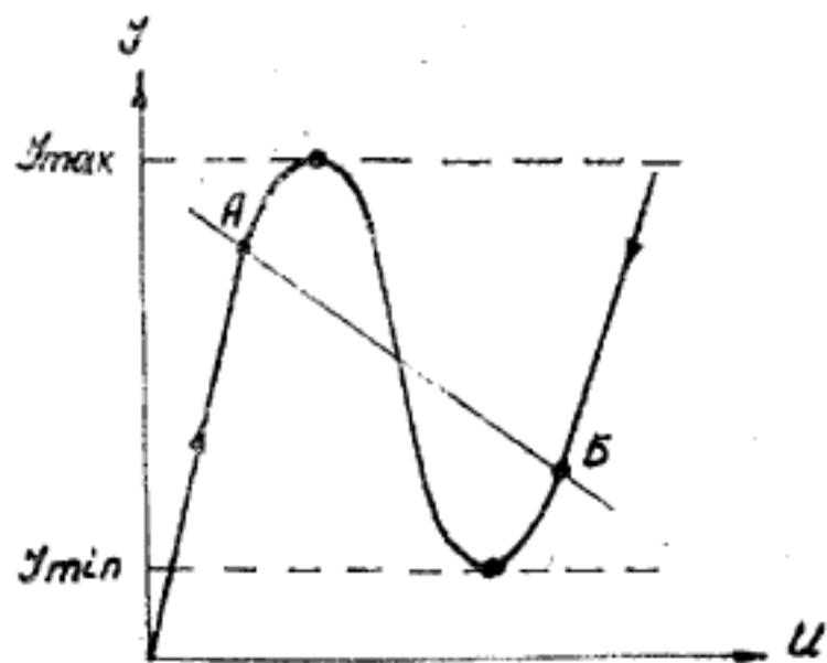
Рис. 2 Вольтамперная характеристика туннельного диода
