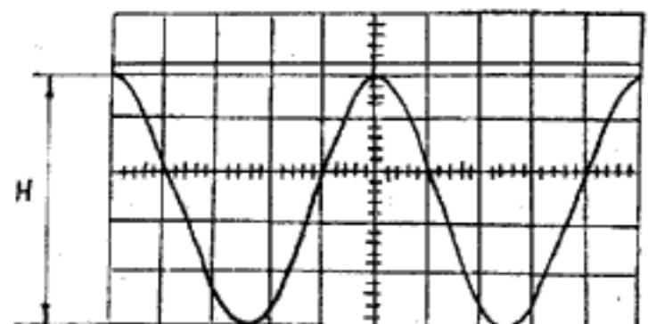
Рис. 3. Измерение полного размаха переменного напряжения
