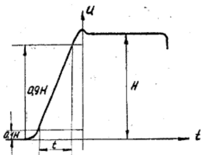
Рис. 7. Измерение времени нарастания.
