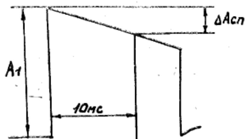
Рис. 18. Измерение спада вершины переходной характеристики.
