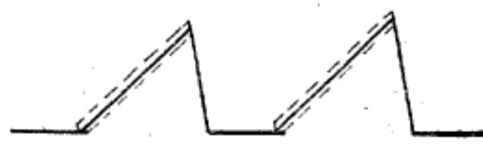
Рис. 8. Регулировка линейности начального участка пилообразного напряжения резистором 3R16.
