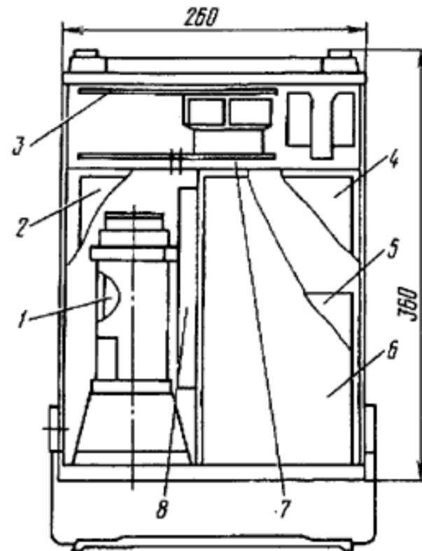
1 - ЭЛТ; 2 - блок усилителя "Y", усилителя "Z" и схема управления ЭЛТ; 3 - преобразователь и выпрямитель; 4 - усилитель вертикального отклонения; 5 - устройство управления; 6 - блок развертки и синхронизации; 7 - преобразователь; 8 - линия задержки
