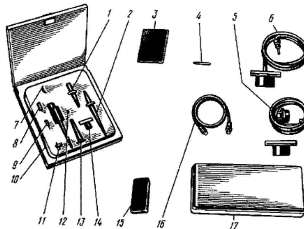
1, 9, 11, 13 - щуп; 2 - делитель; 3 - светофильтр; 4 - отвертка;
