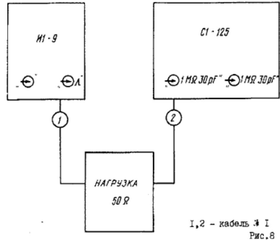
9.3.3.4. Определение погрешности коэффициентов развертки проводить во всех положениях переключателя ВРЕМЯ/ДЕЛ при помощи калибратора И1-9 (рис. 8).
