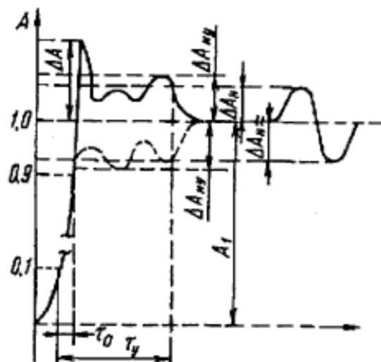
$\tau_0$  - время нарастания;  $\tau_y$  - время установления;  $\Delta A$  - выбросов;  $\Delta A_n$  - неравномерность;  $A_I$  - установившееся значение ПХ;  $\Delta A_{nu}$  - неравномерность на участке установления
