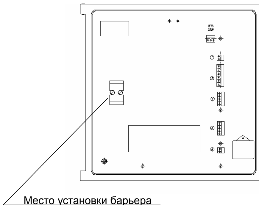
Рисунок 12 – Установка барьера искрозащиты на задней стенке прибора
